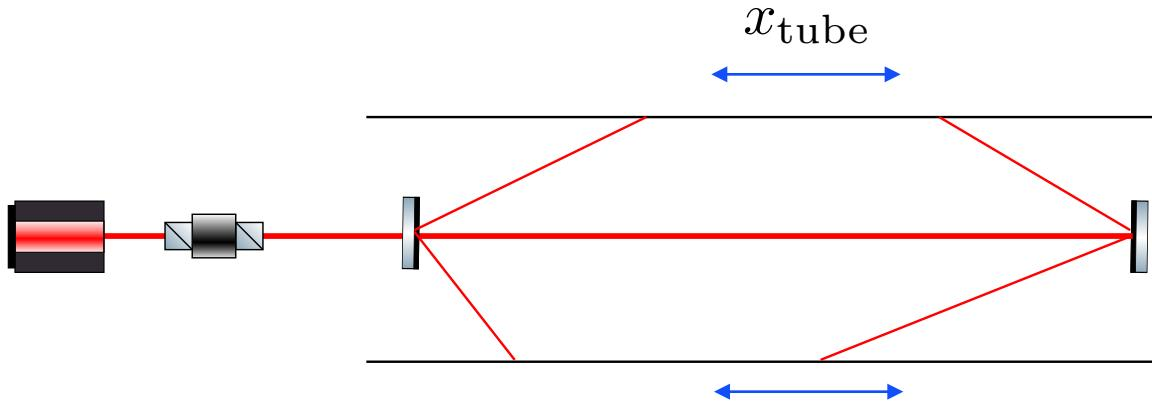
$$h_{\text{noise}} \approx \sqrt{\frac{P_{\text{sc}}}{2P_{\text{arm}}}} \frac{x_{\text{tube}}}{L}$$
